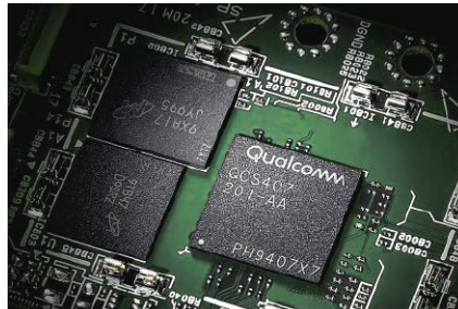
Dekodery surround skupiono w potężnym procesorze marki Qualcomm.
