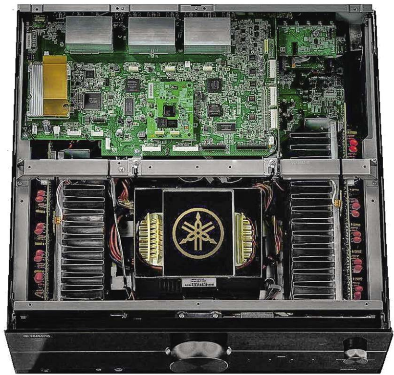
Transformator zasilający (w ekranie) oraz końcówki mocy znajdują się w przedniej sekcji, tylną zajmują układy cyfrowe i przedwzmacniacz.
